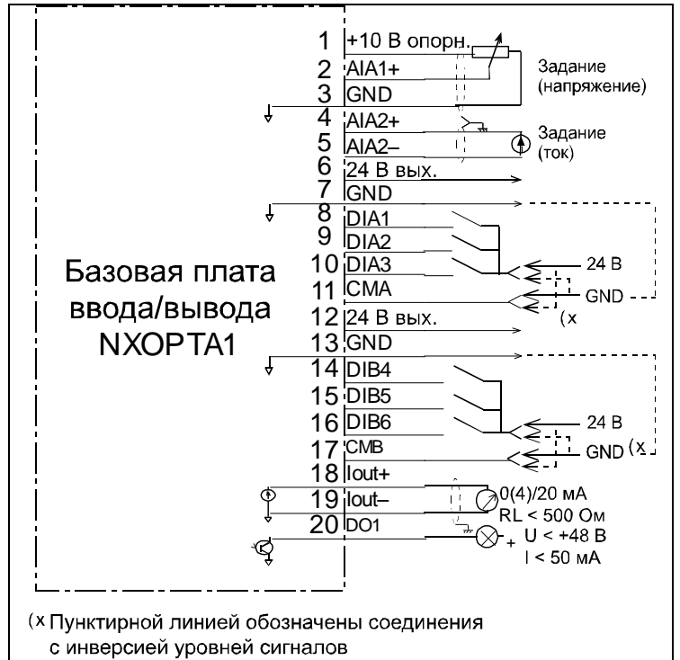
Рис. 6-17. Общая схема подключения цепей базовой платы ввода/вывода (OPT-A1)
