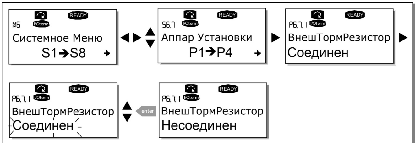
Рис. 7-21. Подключение внутреннего тормозного резистора
