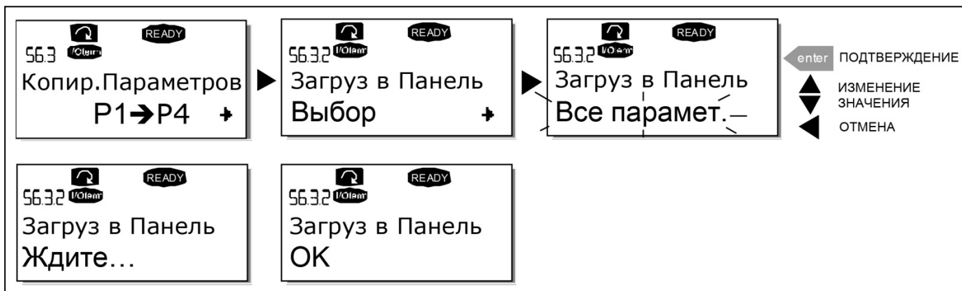
Рис. 7-12. Копирование параметров в панель управления
