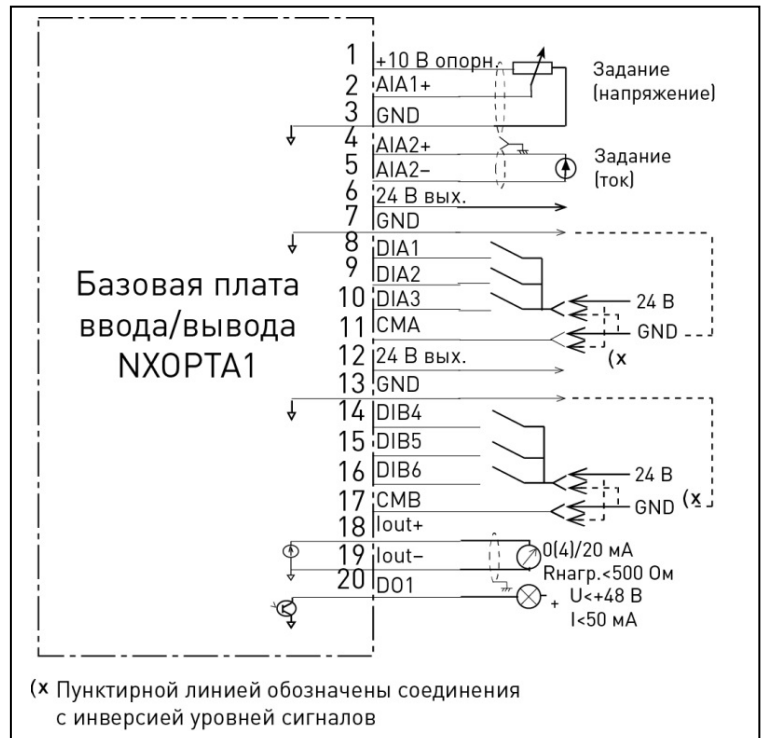
Рис. 6-10. Общая схема подключения цепей базовой платы ввода/вывода (NXOPTA1)
