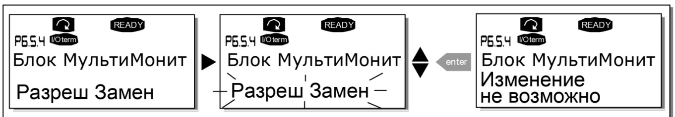
Рис. 7-17. Запрет изменения одновременно контролируемых параметров
