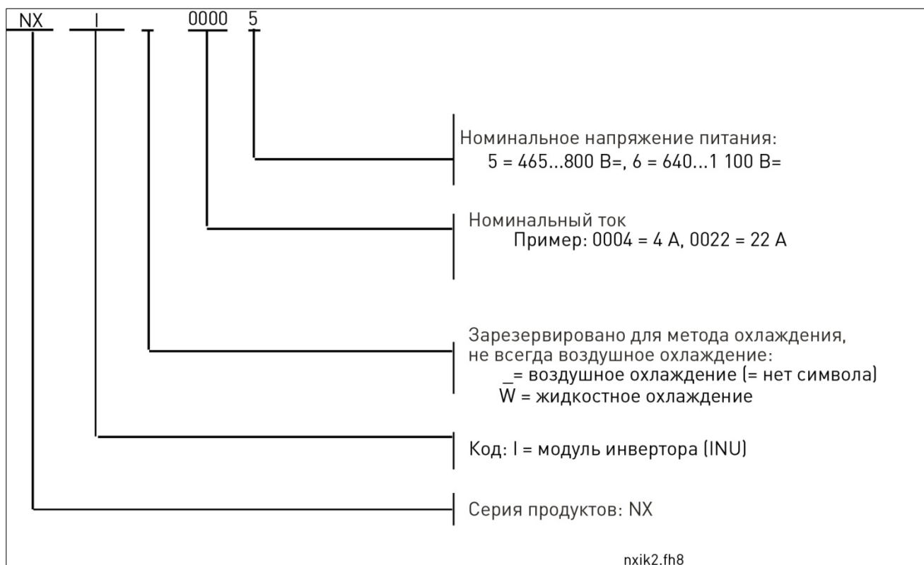
Рис. 3-1. Расшифровка кода обозначения инверторов Vacon NX (FR4–FR8)
