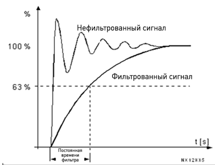
Рис. 14. Фильтрация аналогового выходного сигнала
